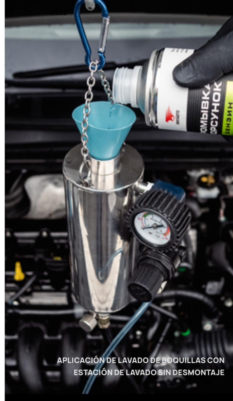
APLICACIÓN DE LAVADO DE BOQUILLAS CON ESTACIÓN DE LAVADO SIN DESMONTAJE
