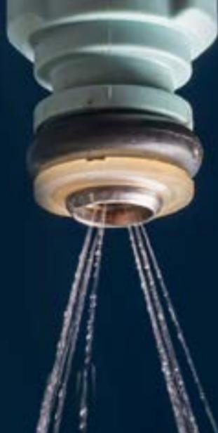
Pulverización del inyector antes de la limpieza
